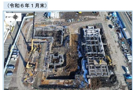
(令和6年1月末) ケビン・炉室・灰・粗大処理エリア基礎工事完了、地階部基礎工事中
